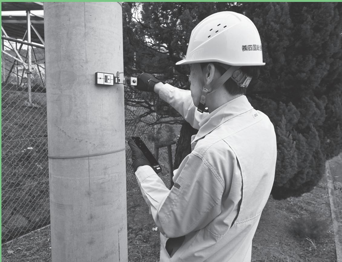
電力柱の鉄筋破断に関する点検作業の様子 写真提供:株式会社四国総合研究所
